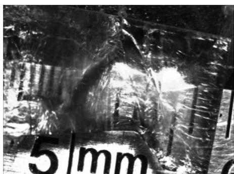
Рис. 1. Оптическая фотография пластинки фторированного высокоориентированного графита
