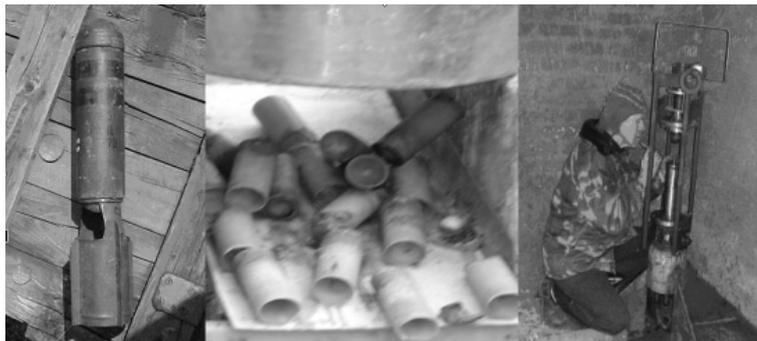
Рис. 3. Боеприпас ПТАБ-2.5 (слева), извлеченное ВВ (в центре), гидравлический съемник головной части (справа)
